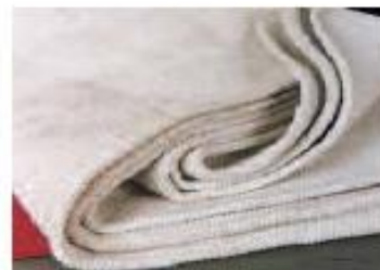
Asbestos fire blanket
